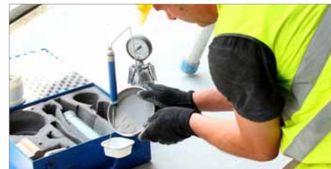
Фото 1. Химический метод измерения влажности.
